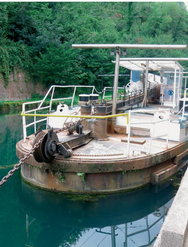
Der elektrische Kettenschlepper, Baujahr 1924
