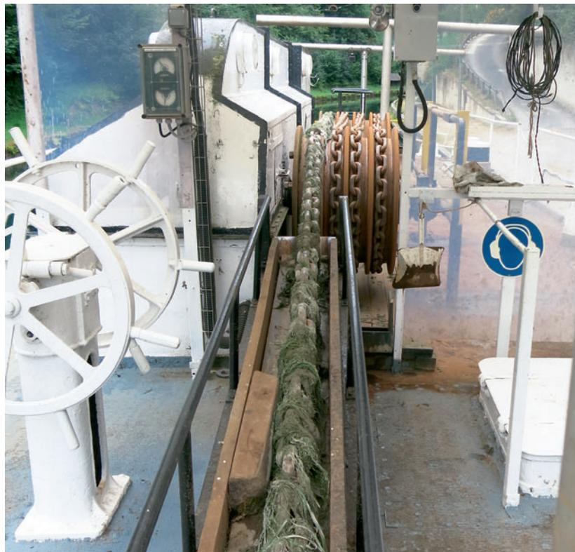
Der Schlepper hangelt sich an der über 5 Kilometer langen Kette durch den Tunnel
