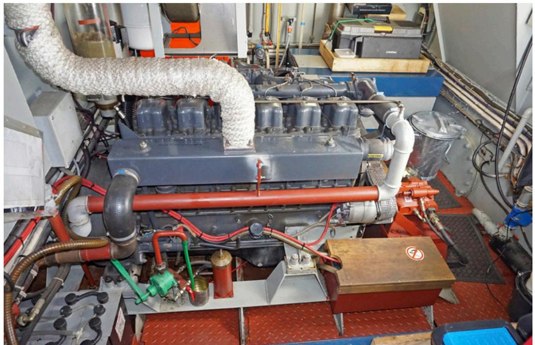
Auch Maschinenräume dürfen Komfort aufweisen. Stehhöhe, rundum gut zugängliche Maschine, Generatoren und Batterien erleichtern das Arbeiten wesentlich. Auf der MS VERANDEREN haben die Maschine und die beiden Generatoren geschlossene Kühlkreisläufe. Das ständige Reinigen von verstopften Wasseransaug-Filtern fällt deshalb weg.
